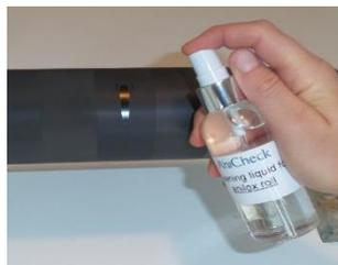
Nettoyer le FerroFluide avec le papier absorbant et le liquide de nettoyage AniCheck
