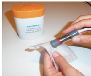
Nettoyer la sonde avec un chiffon imbibé, ou un papier absorbant sec. Ne pas utiliser d'alcool.
