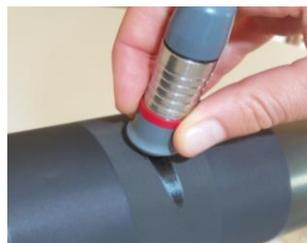
Effectuer *trois* mesures dans le cercle de centrage, avec le FerroFluide
